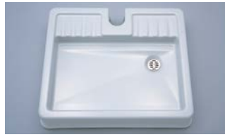
A-5338 ¥29,000 専用防水パン 外寸:620×520×110 内寸:520×315×110 材質:FRP ■ 施工後の仕上面からの外寸高さは60mmになります。
