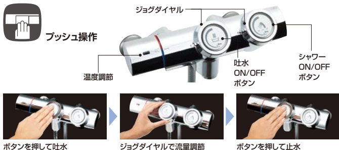
ボタンを押して吐水 ジョグダイヤルで流量調節 ボタンを押して止水
