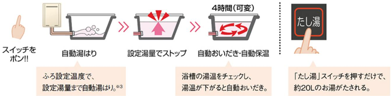
※3 残り湯が循環口より上にある場合は、多少湯量がばらつきます。また、残り湯が設定温に近い場合は、約6リットルだけ湯はります。残り湯が循環口より下にある場合は、新たに設定量の湯はりをします。残り湯分だけ湯量が増えます。
