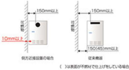
ガス機器と建築物等の離隔距離は、可燃物の場合150mm、不燃物で仕上げをしている場合は、45mmです。パロマの面状の壁面火災防止装置は側面の異常過熱も安全に検知ができる為、『側方近接距離』についても10mmの防火評定を取得しました。
