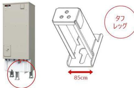
※1 : 角型地階および1階ならびに敷地の部分に設置において。また、取付方法やタンク容量によって対応できる耐震クラスが異なります。370Lタイプは地上階(1階)でのアンカーボルト3本固定で耐震クラスS (KH=1.0) を満足します。460Lタイプは地上階で脚固定金具を併用した固定で耐震クラスS (KH=1.0) を満足します。KHとは設計用水平震度を示します。詳細は、仕様書または裾付工事説明書をご確認ください。
