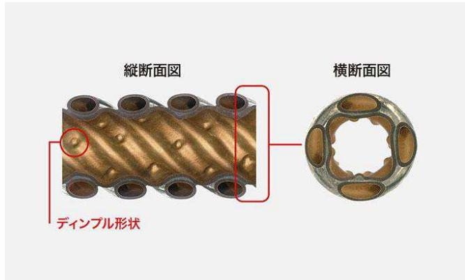
熱交換器の水が通る配管に、冷媒配管4本をツイスト状に巻きつけた4条ガスクーラーを採用。またガスクーラー内面にディンプル形状を追加。これにより配管どうしの接触面積が大きくなると共に、水の流れのかくはんにより熱交換が促進され、効率的に水を加熱できます。
